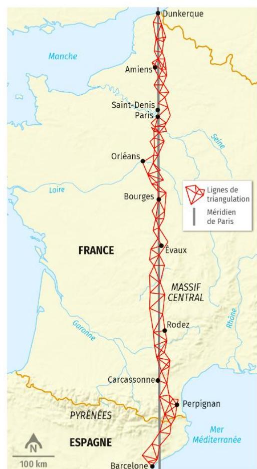
6. Sur le schéma, sachant que l'on connaît la distance  $AB = 11$  km, que les angles déterminés par triangulation sont indiqués et les angles manquants à mesurer avec un rapporteur, calculez la longueur OE représentant une portion de méridien.
