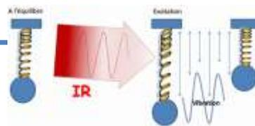
**Des ondes électromagnétiques OEM sont envoyées sur la matière et on regarde celles qui sont transmises et celles qui sont absorbées.**
