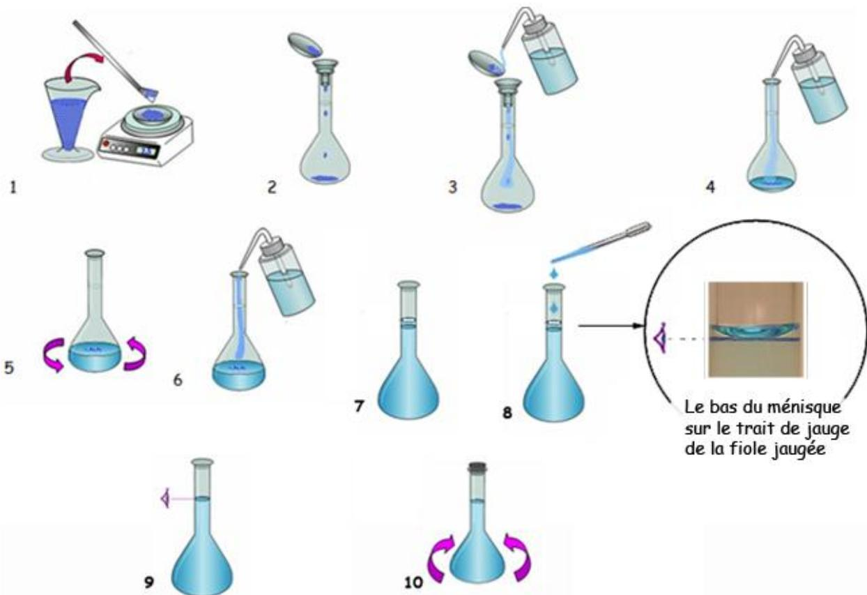
**1** : Le plateau de la balance étant propre, on dépose un verre de montre et on appuie sur la fonction « tare ». La masse affichée est maintenant nulle. Après avoir pris le sel avec une coupelle, celui-ci est déposé délicatement de façon à obtenir la masse souhaitée.
