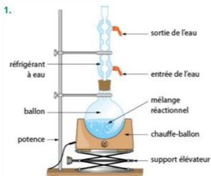
2. Le chauffage à reflux permet de chauffer le mélange réactionnel (pour accélérer la transformation chimique) sans pertes par évaporation, puisque les vapeurs se liquéfient dans le réfrigérant vertical et retombent dans le ballon.
