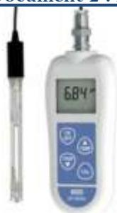
Un pHmètre est constitué d'une sonde (pHmétrique) et de son boîtier de mesure.
