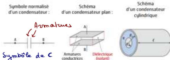
Un **condensateur** est un système composé de deux surfaces conductrices en regard, appelées **armatures**, séparées par un matériau **isolant**.
