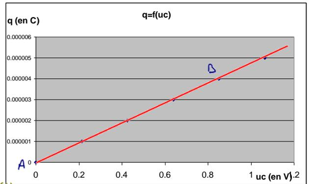
La courbe  $q(t) = f(u_c)$  est une droite passant par l'origine. Donc  $q(t)$  et  $u_c(t)$  sont proportionnelles.  $q(t) = k \times u_c(t)$
