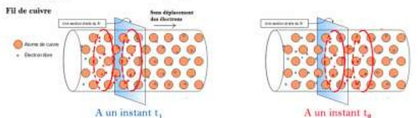
Un **courant électrique noté I** correspond à **déplacement de porteur de charge**.
