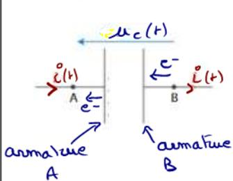
des électrons s'accumulent sur l'armature B : elle devient négative.
