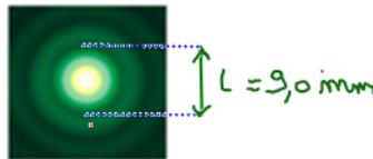
Diffraction par un trou (et non par une fente ou un fil)
