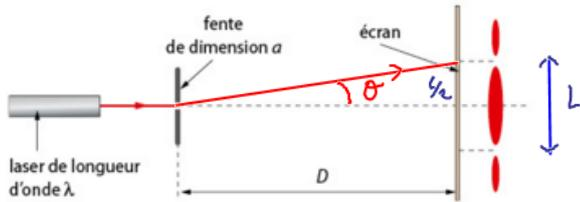
2) a) Caractéristique de l'angle  $\theta$  de diffraction
