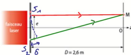
Un laser rouge, de longueur d'onde  $\lambda = 633 \text{ nm}$ , éclaire deux petits trous espacés d'un écartement  $e$ . On se place au point M.
