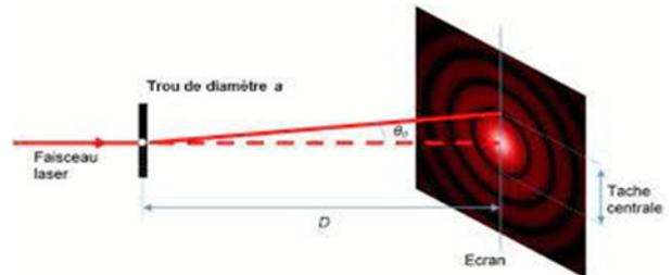
1) Si il y avait pas de phénomène de diffraction on obtiendrait un spot lumineux de la taille du trou
