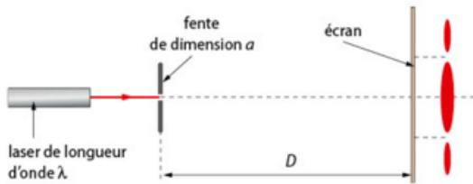
1. Reproduire le schéma ci-dessus et indiquer la position des premières extinctions, la largeur  $L$  de la tache centrale de diffraction et l'angle caractéristique de diffraction  $\theta$ .
