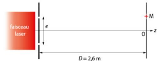
Un laser rouge, de longueur d'onde  $\lambda = 633$  nm, éclaire deux petits trous espacés d'un écartement  $e$ . On se place au point M.
